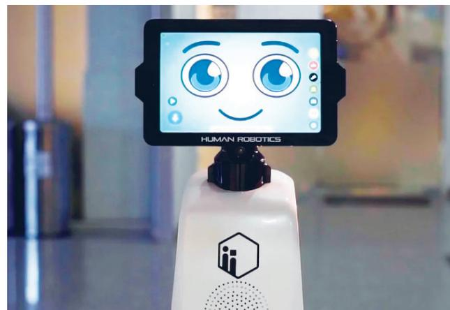
Robio, um robô de telepresença desenvolvido para automatizar residências
